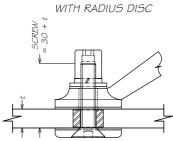
M8 AGA NUT M8 SPRING WASHER 20 x 2 x M8 FLAT WASHER 20 x 0.8 x M8 FIBRE GASKET 444 SPIDER PALM 444 SPILJER FALM 35 x 0.8 x M8 FIBRE GASKET 14 x 8.5 BUJH, TO SUIT GLASS THICKNESS 35 x 0.8 x M8 FIBRE GASKET 35 x 4 x M8 BACKING DISC
