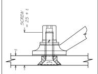
M8 AGA NUT M8 SPRING WASHER 20 x 2 x M8 FLAT WASHER 20 x 0.8 x M8 FIBRE GASKET 444 SPIDER PALM 35 x 0.8 x M8 FIBRE GASKET M8 C9K BU9H, TO SUIT GLASS THICKNESS
