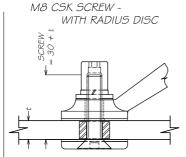
M8 AGA NUT M8 SPRING WASHER 20 x 2 x M8 FLAT WASHER 20 x 0.8 x M8 FIBRE GASKET 444 SPIDER PALM 35 x 0.8 x M8 FIBRE GASKET 14 x 8.5 BUSH, TO SUIT GLASS THICKNESS 35 x O.8 x M8 FIBRE GASKET
