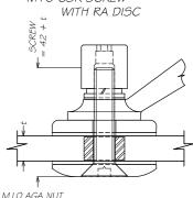
MIO SPRING WASHER 20 x 2 x MIO FLAT WASHER 20 x 0.8 x MIO FIBRE GASKET 444 SPIDER PALM 50 x Gmm DISC
